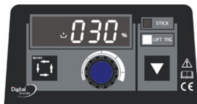
Схема 10: Регулирование основного тока без импульса постоянного тока в режиме LIFT TIG
