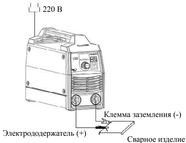
Схема подключения MMA 160 Digital для MMA сварки
